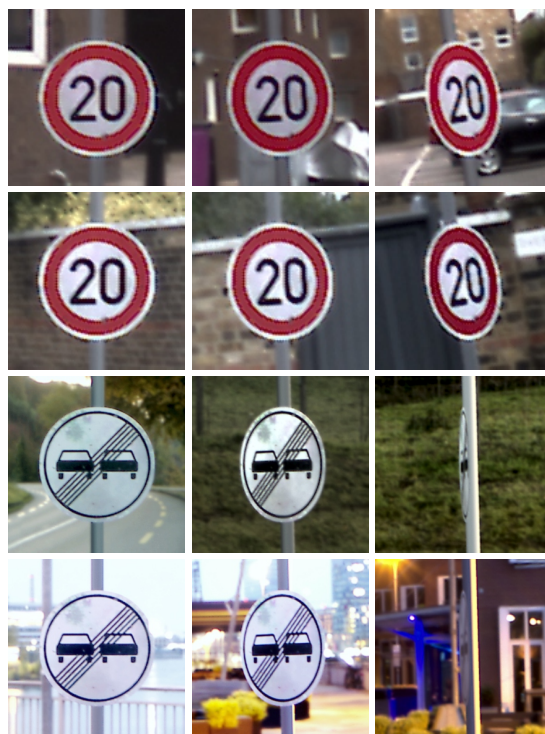
Abb. 7: Synthetische Daten erlauben gezielte Variationen, die in Realität unmöglich sind: Die Abbildung zeigt für zwei Verkehrsschildklassen jeweils das erste Bild der sechs Teildatensätze im Synset®-Signset-Variationsdatensatz. Das identische Schild mit identischen Kratzern erscheint in drei verschiedenen Winkeln und in zwei verschiedenen Umgebungen, und erlaubt so gezielte Analysen, wie Kontext das Training von neuronalen Netzen beeinflusst.
