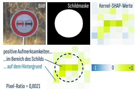
Abb. 8: Der »Pixel-Ratio« errechnet sich durch die positiven Kernel-SHAP-Werte innerhalb der Schildfläche, geteilt durch die Summe aller positiven Kernel-SHAP-Werte im Bild. Er misst intuitiv, wie relevant der Schildinhalt für die Klassifikation war, im Vergleich zum Hintergrund.
