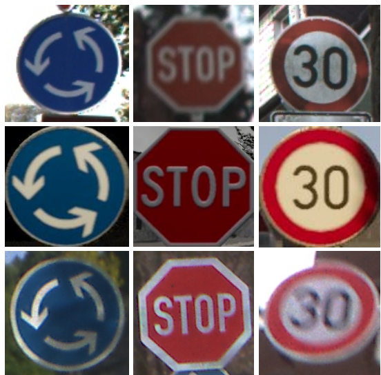
Abb. 5: Vergleich von Bildern des realen GTSRB-Datensatzes (oben) mit ähnlichen Bildern des synthetischen CATERED-Datensatzes (mitte), sowie des neu erzeugten synthetischen Synset®-Boulevard-Datensatzes (unten).
