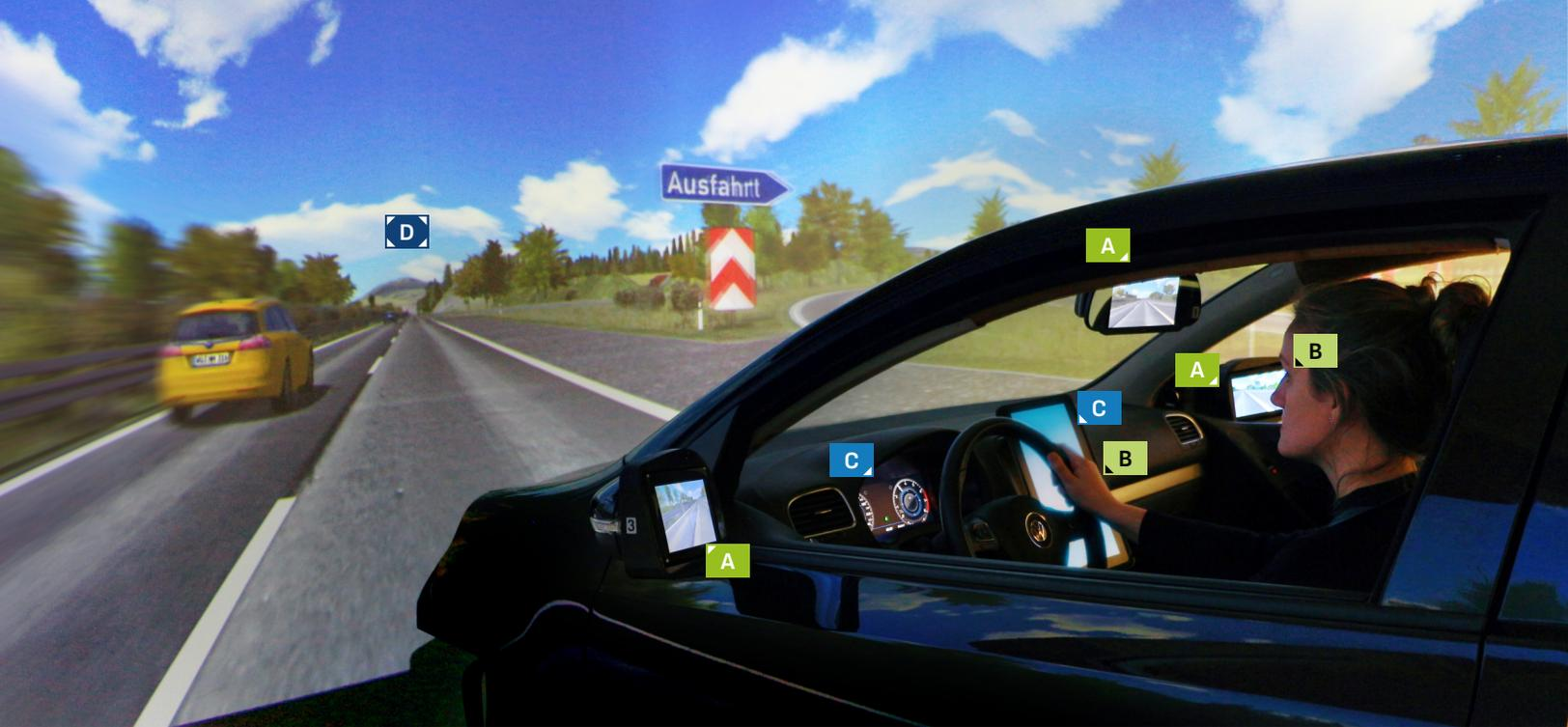
**Abb. 1:** Der Fahrsimulator verfügt über digitale Rückspiegel (A) und die Möglichkeit, detailliert den Insaszustand zu erheben (B), beispielsweise die Blickposition über Eye-Tracking oder Steuereingaben. Die vollständig digitalen Interieurdisplays (C) können nach Studienbedarf angepasst werden. Auf der 180°-Panoramaleinwand (D) können Fahrszenarien und Umgebungsbedingungen immersiv simuliert werden.
