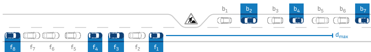
Abb. 2: Beispielhafte Situation an der Engstelle, wobei Fahrzeuge mit der kooperativen Funktion blau gefüllt dargestellt sind, alle anderen (zum Beispiel menschlich gefahrene) Fahrzeuge als Umrisse. Die Fahrzeuge auf dem blockierten Streifen ( b_1, \dots, b_7 ) müssen darauf warten, dass eines der Fahrzeuge auf dem freien Streifen ( f_1, \dots, f_8 ) ihnen die Vorfahrt gewährt. Ziel war es, eine Methode zu finden, wie sich die kooperativen Fahrzeuge über Funk auf eine Strategie verständigen können. Die vorgeschlagene Lösung besteht darin, dass jedes kooperative Fahrzeug auf dem freien Streifen (genauer gesagt vermutlich: die Passagiere des jeweiligen Fahrzeugs) einen Wert d_{\max} auswählen, der angibt, wie viele blockierte Fahrzeuge sie maximal abfließen lassen würden.
