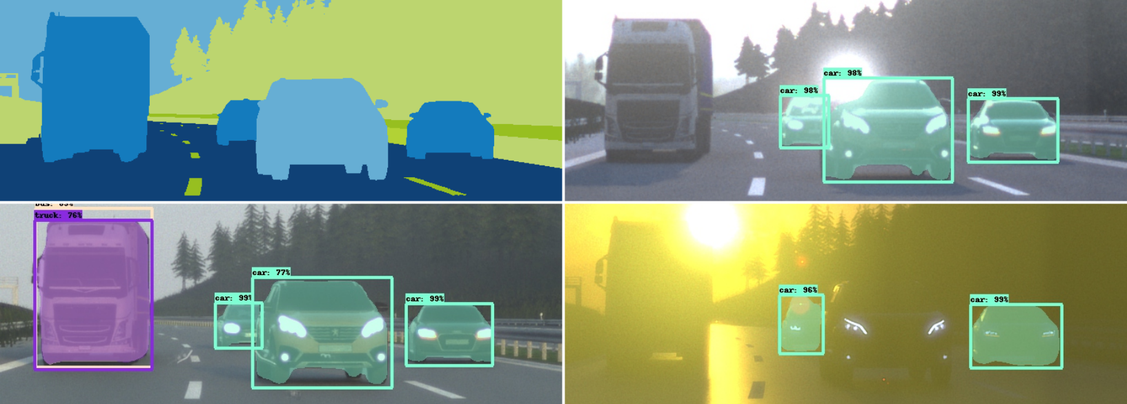
Abb. 5: Die Simulation kritischer Situation erlaubt die gezielte Variation von Parametern, um Schwächen im System eines automatisierten Fahrzeugs zu identifizieren – im menschlichen Fahrverhalten ebenso wie etwa in der KI-basierten Sensorauswertung unter verschiedenen Lichtsituationen, wie hier in der Simulation OCTANE, deren Entwicklung im Rahmen von KAMO vorangetrieben wurde. Zudem erlaubt Simulation den direkten Abgleich zur vollständig bekannten Realität, wie oben links dargestellt.
