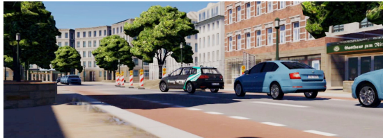
Abb. 4: Bild der Szenariosimulation in OCTANE 3 mit einer zweistreifigen Straße auf der eine Fahrtrichtung durch eine Baustelle blockiert ist. Die Fahrzeuge in dieser Richtung müssen in den Gegenverkehr wechseln. Im dichten Verkehr geht das nicht, ohne dass ein entgegenkommendes Fahrzeug die Vorfahrt gewährt.
